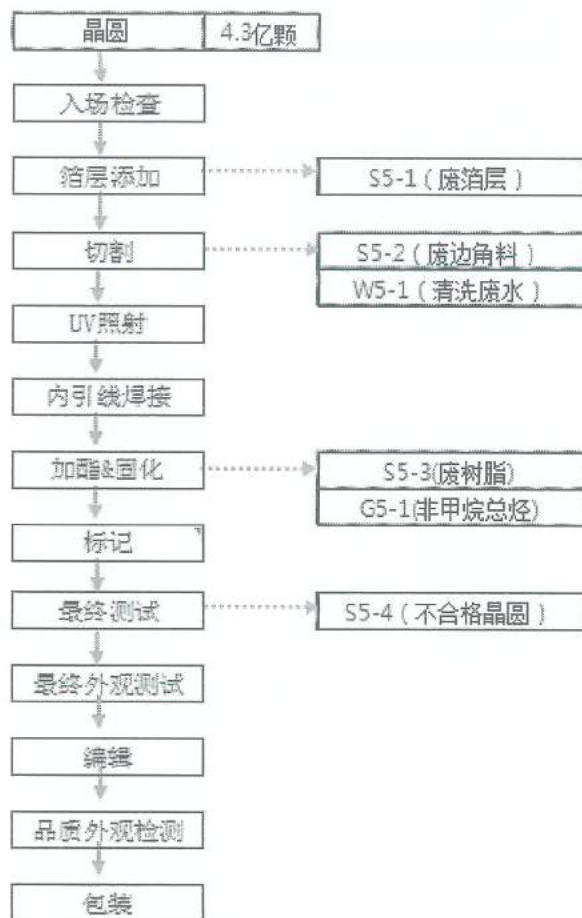
图3.3-6 COF1封装工艺流程图
