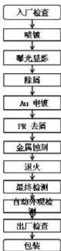
图 4.1-3 8 吋金凸块生产工艺流程
